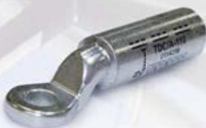
Los terminales bimetalicos TDC/A están fabricados en tubo de aleación de aluminio de pureza igual o superior al 99,5%. Mediante un baño electrolítico se cubre de estaño toda la superficie del conector. Lleva incorporada grasa neutra en el agujero para evitar la oxidación del aluminio. Especialmente diseñado para conexiones con cable aéreo.
