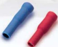
Los terminales preaislados ACH están fabricados con fleje de cobre electrolítico y aislamiento en PVC. Incorporan un casquillo interior que confiere una mayor seguridad para soportar posibles vibraciones mecánicas.
