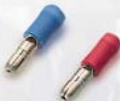
Los terminales preaislados ACM están fabricados con fleje de cobre electrolítico y aislamiento en PVC. Incorporan un casquillo interior que confiere una mayor seguridad para soportar posibles vibraciones mecánicas.
