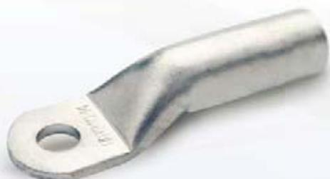
Los terminales TL están fabricados en cobre electrolítico con un acabado superficial estañado para mejorar el contacto eléctrico. La mayor longitud de la caña permite asegurar una mejor conexión eléctrica en condiciones más desfavorables. Según norma CEI 61238-1.
