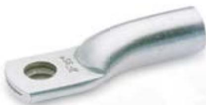
Los terminales TBE están fabricados en tubo de aleación de aluminio de pureza igual o superior al 99,5%, con un acabado superficial estañado para mejorar el contacto eléctrico. Lleva incorporada grasa neutra en el agujero para evitar la oxidación del aluminio.
