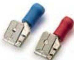
Los terminales preaislados AFH/M están fabricados con fleje de cobre electrolítico y aislamiento en PVC. Incorporan un casquillo interior que confiere una mayor seguridad para soportar posibles vibraciones mecánicas.
