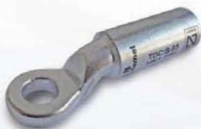
Los terminales bimetalicos TDC/S están fabricados en tubo de aleación de aluminio de pureza igual o superior al 99,5%. Mediante un baño electrolítico se cubre de estaño toda la superficie del conector. Lleva incorporada grasa neutra en el agujero para evitar la oxidación del aluminio. Especialmente diseñado para conexiones con cable subterráneos. Según norma UNE 211024 Poseen la marca del certificado AENOR.
