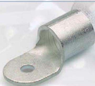
Los terminales TD están fabricados con fleje de cobre soldado con un acabado superficial estañado para mejorar el contacto eléctrico. Según DIN 46234.
