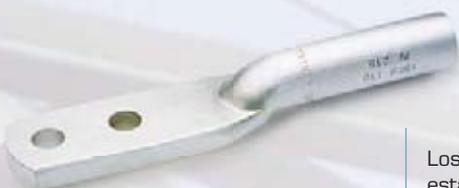
Los terminales bimetálicos TBEM/A están fabricados en tubo de aleación de aluminio de pureza igual o superior al 99,5%. Mediante un baño electrolítico se cubre de estaño toda la superficie del conector. Lleva incorporada grasa neutra en el agujero para evitar la oxidación del aluminio. Diseñado para conexiones con cables aéreos.
