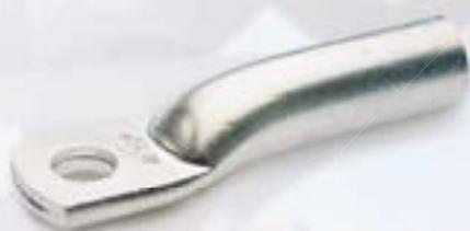
Los terminales TBES están fabricados en tubo de aleación de aluminio de pureza igual o superior al 99,5%, con un acabado superficial estañado para mejorar el contacto eléctrico. Lleva incorporada grasa neutra en el agujero para evitar la oxidación del aluminio. La mayor longitud de la caña permite asegurar una mejor conexión eléctrica en condiciones más desfavorables.
