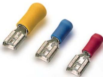
Los terminales preaislados AFH están fabricados con fleje de cobre electrolítico y aislamiento en PVC. Incorporan un casquillo interior que confiere una mayor seguridad para soportar posibles vibraciones mecánicas.
