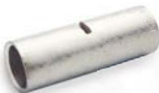
Los manguitos M están fabricados en cobre electrolítico con un acabado superficial estañado para mejorar el contacto eléctrico. Incorporan un tope central que facilita el posicionamiento del cable.
