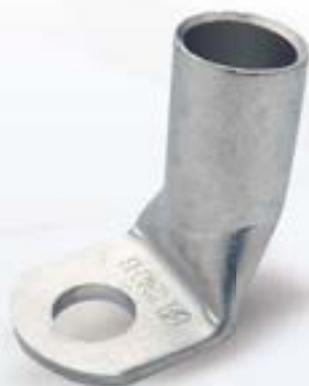
Los terminales T90° están fabricados en cobre electrolítico con un acabado superficial estañado para mejorar el contacto eléctrico. Su particular orientación los hace idóneos en instalaciones donde la conexión requiera de una ubicación determinada. Según norma CEI 61238-1.
