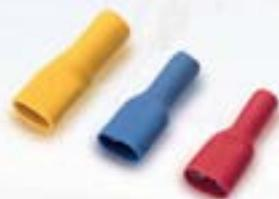
Los conectores AFH/A están fabricados con fleje de cobre electrolítico y aislamiento en PVC. Incorporan un casquillo interior que confiere una mayor seguridad para soportar posibles vibraciones mecánicas.
