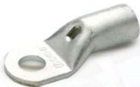
Los terminales T están fabricados en cobre electrolítico con un acabado superficial estañado para mejorar el contacto eléctrico. Incorporan agujero de inspección para verificar el correcto posicionamiento del cable. Según norma CEI 61238-1.
