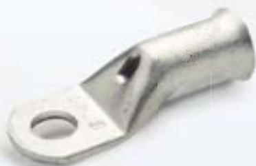
Los terminales TT están fabricados en cobre electrolítico con un acabado superficial estañado para mejorar el contacto eléctrico. El abocardado en el extremo de la caña favorece la introducción del cable.
