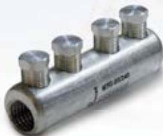
Los manguitos MTG están fabricados por fundición de aluminio. Los tornillos rompen a un par de apriete aproximado de 40 Nm. Según norma UNE 211024.
