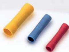
Los manguitos preaislados AML están fabricados con fleje de cobre electrolítico y aislamiento en PVC. Incorporan un casquillo interior que confiere una mayor seguridad para soportar posibles vibraciones mecánicas.
