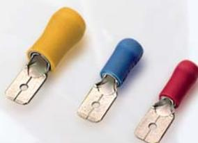
Los terminales preaislados AFM están fabricados con fleje de cobre electrolítico y aislamiento en PVC. Incorporan un casquillo interior que confiere una mayor seguridad para soportar posibles vibraciones mecánicas.
