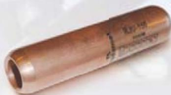
Los manguitos de cobre de media tensión RJU están fabricados en barra de cobre electrolítico. Incorporan un tope central que divide el conector en dos partes iguales.
