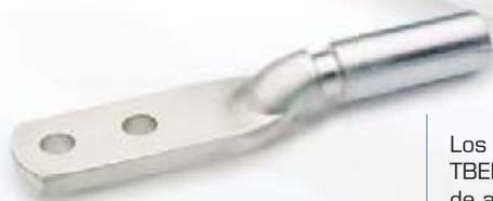
Los terminales bimetálicos TBEM/S están fabricados en tubo de aleación de aluminio de pureza igual o superior al 99,5%. Mediante un baño electrolítico se cubre de estaño toda la superficie del conector. Lleva incorporada grasa neutra en el agujero para evitar la oxidación del aluminio. Diseñado para conexiones con cables subterráneos.
