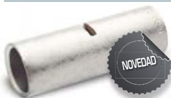
Los manguitos MCD están fabricados en cobre electrolítico con un acabado superficial estañado para mejorar el contacto eléctrico. Según DIN 46267.
