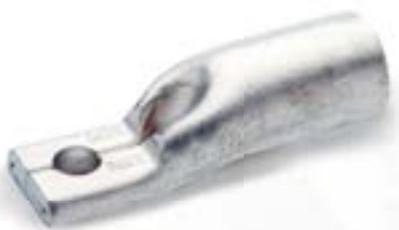
Los terminales TPE están fabricados en cobre electrolítico con un acabado superficial estañado para mejorar el contacto eléctrico. El diseño estrecho de la pala los hace idóneos para espacios reducidos. Según norma CEI 61238-1.
